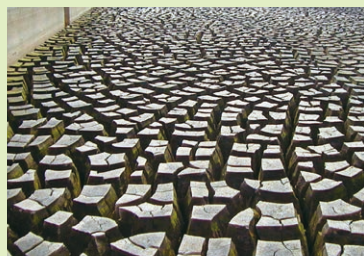
天日乾燥中の浄水発生土
