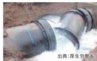
▲東北地方太平洋沖地震による送水管の抜け出し(宮城県)
